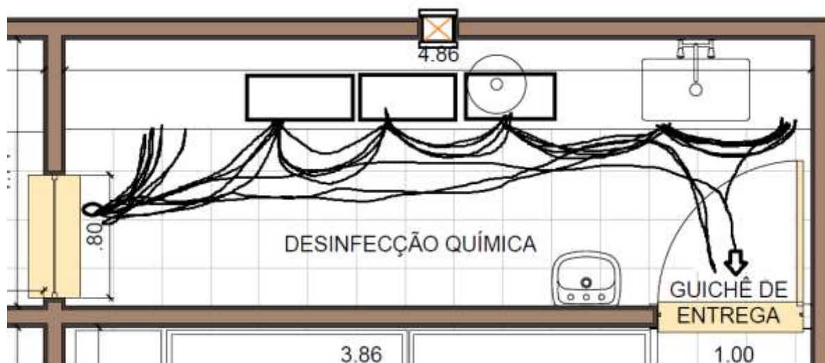
Figura 3. DE do fluxo de movimentação das atividades realizadas na sala de desinfecção química. São Carlos, 2022.
