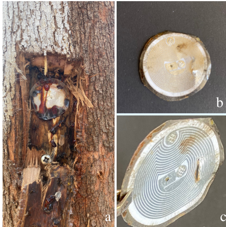
Figura 18 - Etiquetas NFC inutilizadas sendo a – sensor com resina; b e c sensor quebrado.
