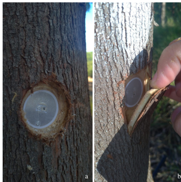
Figura 16 - Sensores instalados sendo a – abertura com a broca serra copo e b – abertura tipo janela.
