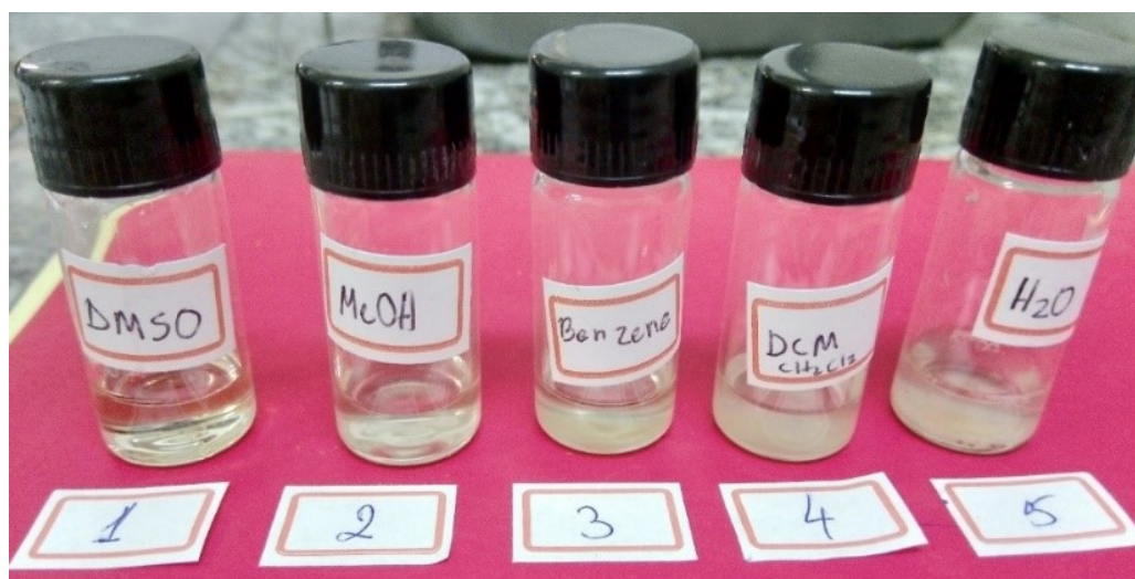
FIGURA 3.7 – Ensaio de solubilidade para determinação empírica dos parâmetros de Hansen. Os frascos representam exemplos da análise qualitativa de solubilidade da hesperidina e suas pontuações.
