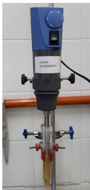
FIGURA 3.3– Equipamento de extração por EAH em procedimento de extração de resíduo de processamento de manga.
