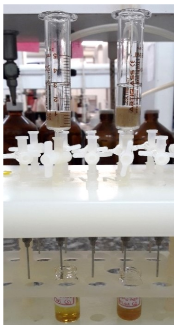
FIGURA 3.4– Sistema de extração por DMFS para extrato de manga.
