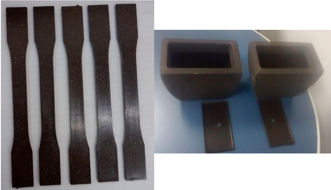
Figura 9: Peças moldadas a partir dos compósitos de cacau desenvolvidos. a) corpos de prova moldados por injeção, e b) peças rotomoldadas.
