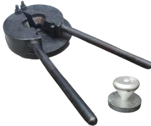
Figura 1 – Molde e amostra com formato padronizado pela Norma ASTM para análise em Espectrômetro de Emissão óptica (OEE)
