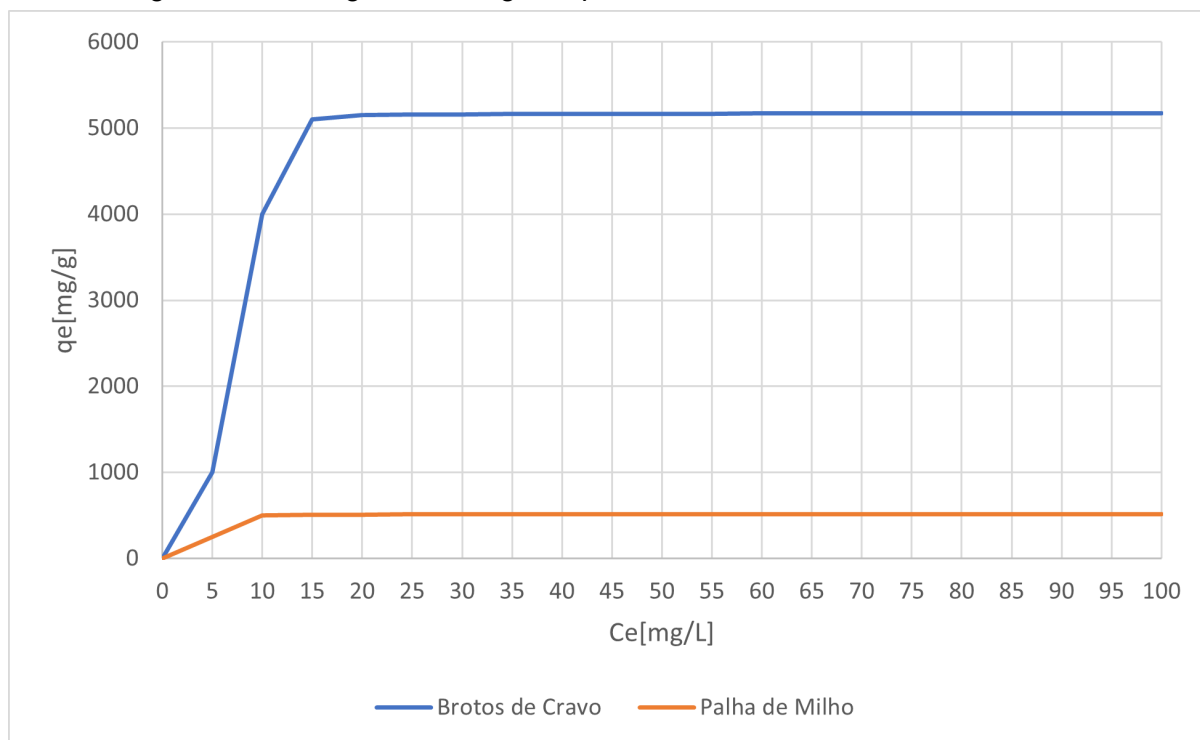
Figura 3: Modelagem de Langmuir para Brotos de Cravo e Palha de Milho.
