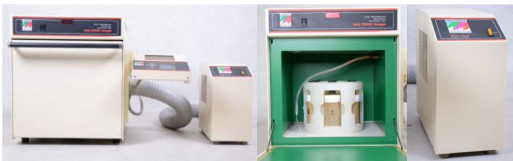
Figura 4 - Sistema de digestão por radiação MO, MLS-1200 Mega (Milestone s.r.l., Soriso, Itália).
