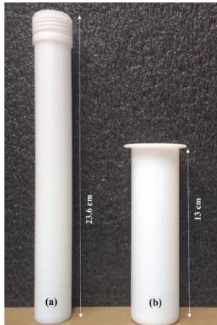
Figura 8 - Frascos reacionais dos rotores MAXI-44 (a) com 26,3 cm de altura e do rotor SK-15 (b) com 13 cm de altura.
