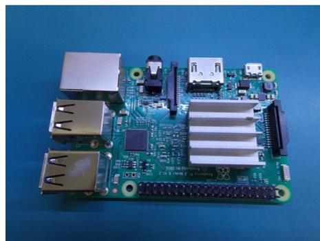
Figura 58 – Placa Raspberry Pi 3 empregada para o recebimento e processamento dos sinais.
