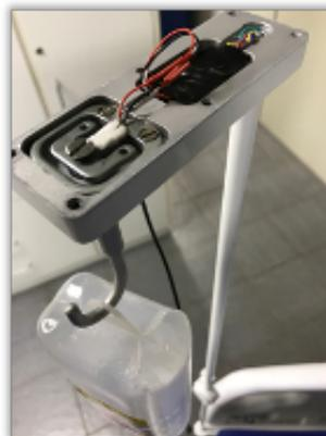
Figura 39 – Protótipo do suporte de soro desenvolvido.
