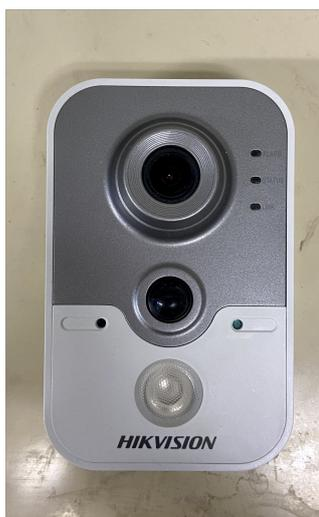
Figura 54 – Câmera com modo noturno utilizada no protótipo.
