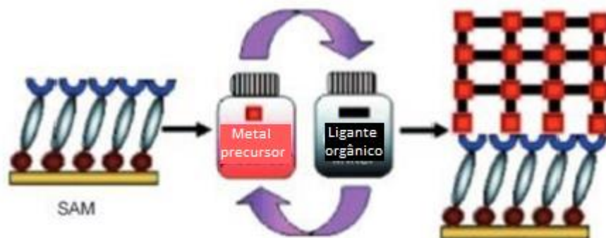
Figura 2. Exemplo de crescimento do MOF layer-by-layer (LBL). Adaptado de [5]
