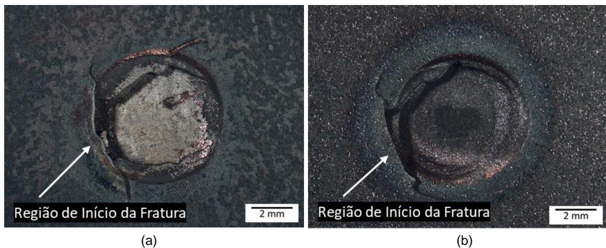
*Figura 48: Fractografia dos pontos de solda após teste de cisalhamento. (a) Fractografia da amostra oxidada. (b) Fractografia da amostra jateada. (Fonte: Próprio autor)*
