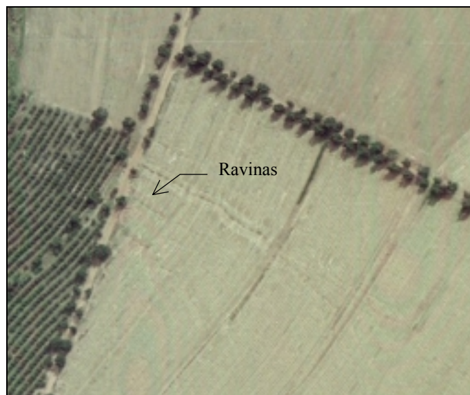
Figura 60: Ocorrência nº 9 - Perda de solo com formação de sulcos isolados e ravinas.
