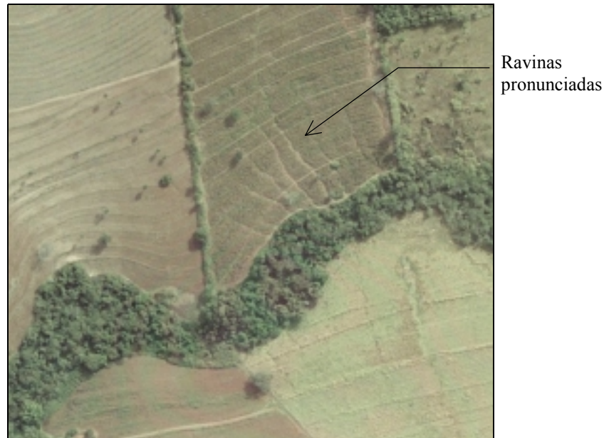
Figura 64: Ocorrência nº 10 – Vista aérea da região de ocorrência nº 10 mostrando os sulcos decorrentes da concentração de drenagem
