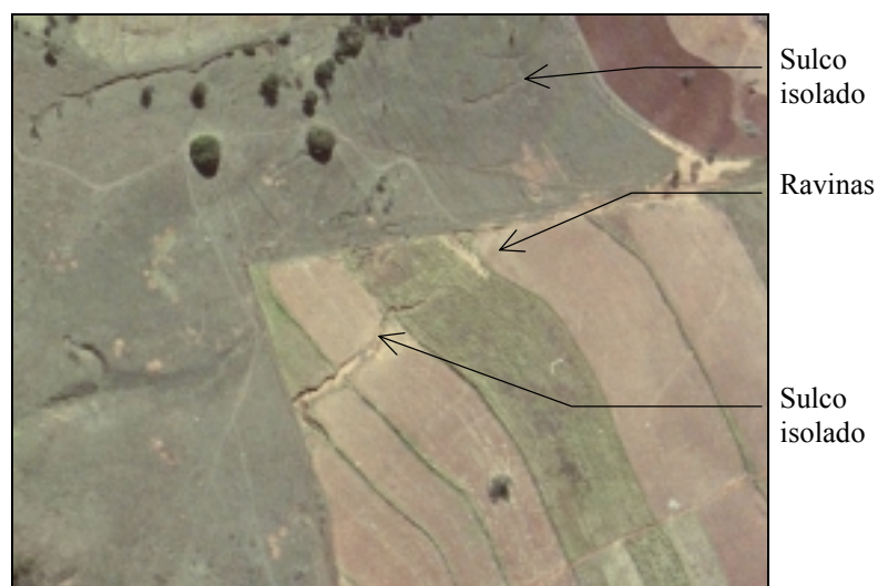
Figura 82: Ocorrência nº 16 - Sulcos erosivos acontecem no contato entre pasto e culturas de milho e cana-de-açúcar.
