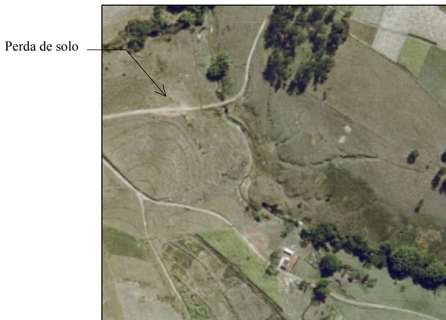
Figura 72: Ocorrência nº 12 - Sulcos de erosão em solos rasos e depósitos de sedimentos na porção inferior do terreno
