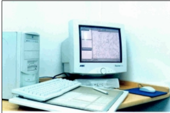
Figura 23: Mesa digitalizadora acoplada ao computador operando o programa CartaLinx.
