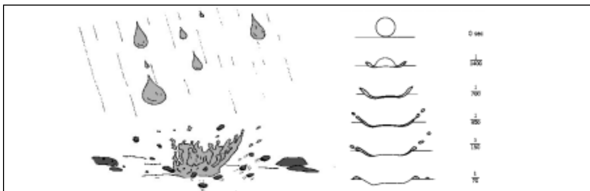
Figura 2: Impacto das gotas de chuva no solo – etapas da desagregação do solo pela gota d'água.
