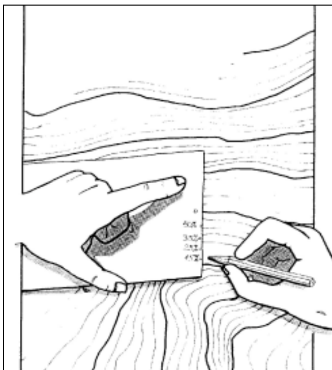
Figura 9: Gabarito para determinação de classes de declividade.
