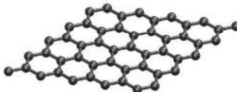
Figura 3.9 – Estrutura hexagonal do grafeno.
