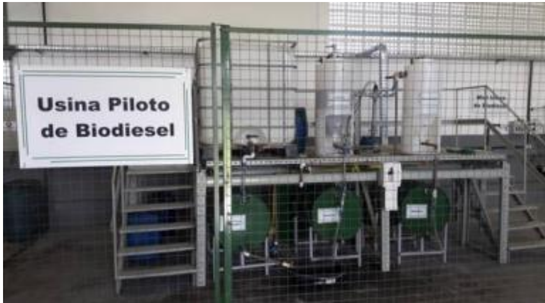
Figura 33 – Unidade de reciclagem de óleo visando a obtenção de biodiesel a partir de óleo usado - BERSO / UFPE
