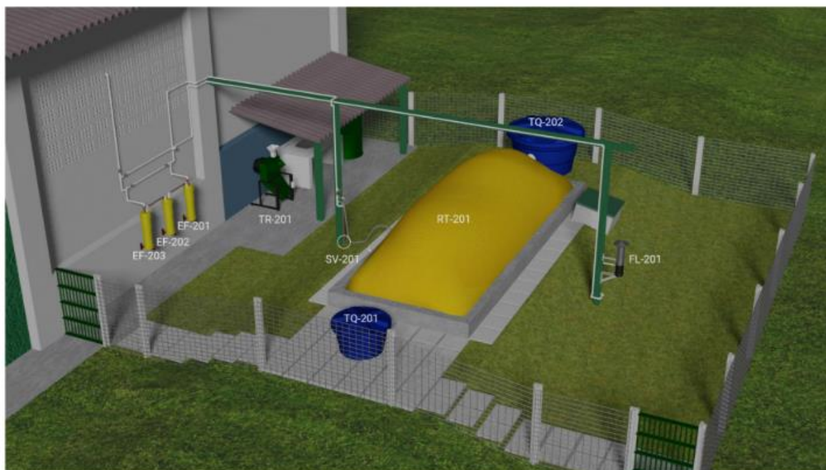
Figura 43 – Planta piloto de baixo custo desenvolvida para produção de biogás e biofertilizante a partir de resíduos de alimentos (BERSO)
