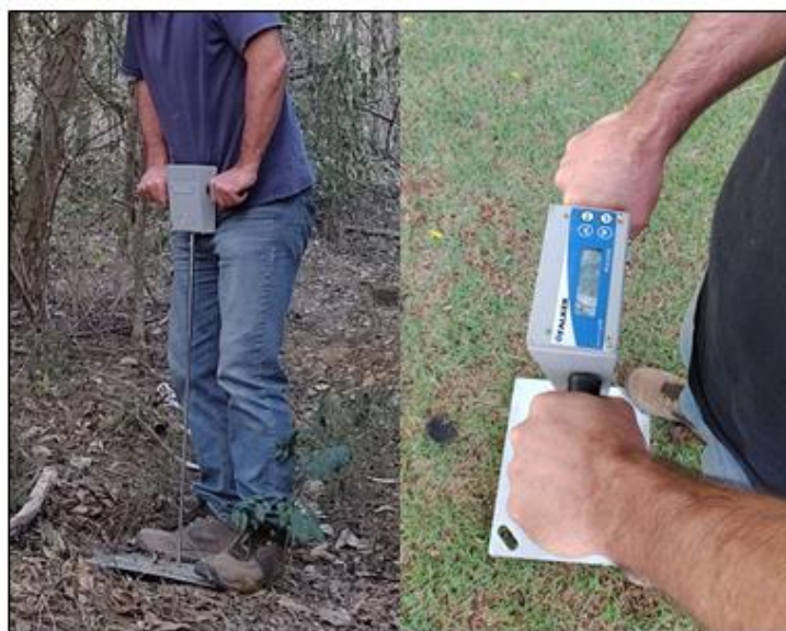
Figura 9: Ensaio de resistência do solo à penetração (RP), realizado com o penetroLOG – medidor eletrônico de compactação do solo.
