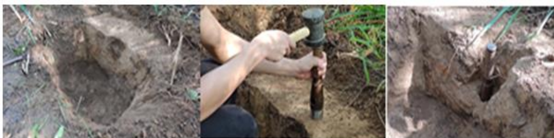
Figura 5- Minitrincheira (esquerda), coleta se amostra de solo indeformada 0-20 cm (centro), coleta de amostra de solo indeformada 20-40 cm (direita).
