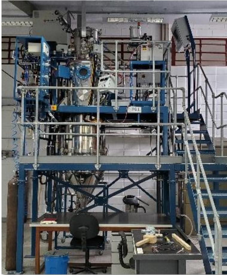
**Figura 19** - Imagem do atomizador a gás HERMIGA 75/5VI.
