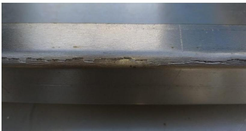
**Figura 15.** Vista da região externa da dobra de um aço Inox AISI 304, evidenciando as fissuras e a propagação da trinca.
