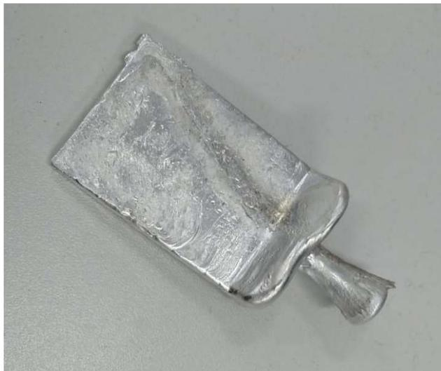
Figura 11: Chapa da liga 2017 produzida por meio da utilização do forno de centrifugação.
