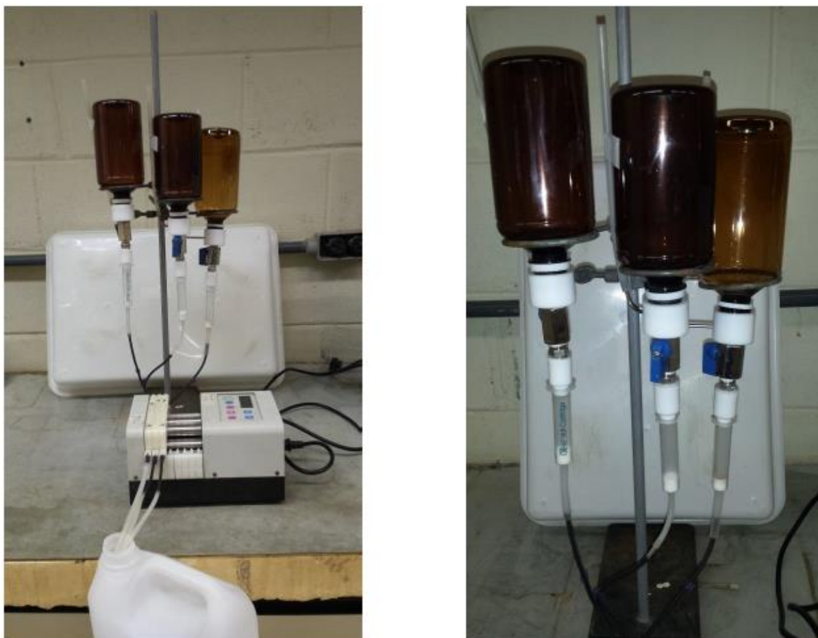
Figura 5.1- Sistema de extração em fase sólida (SPE), montado no laboratório, baseado no sistema desenvolvido por SODRÉ et al., 2010. (Foto: GROSSELI, 2016).
