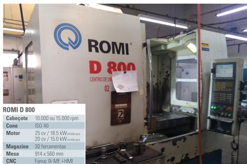
Figura 17 - Características Técnicas – ROMI modelo D800
