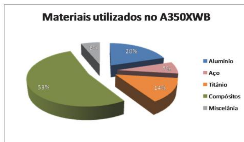
Figura 2 - Materiais utilizados na fabricação do A350 XWB.
