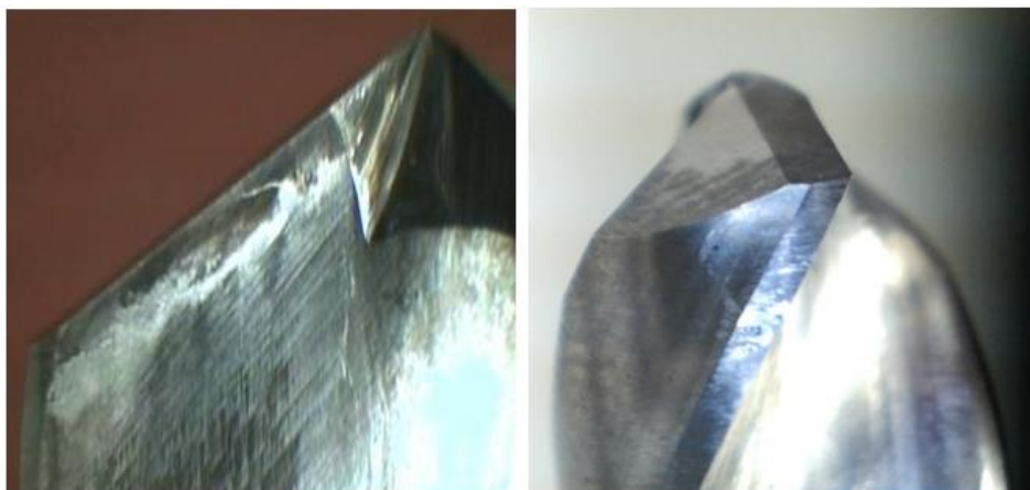
Figura 43 - Broca, com ângulo de hélice de 40°, após 196 furos.
