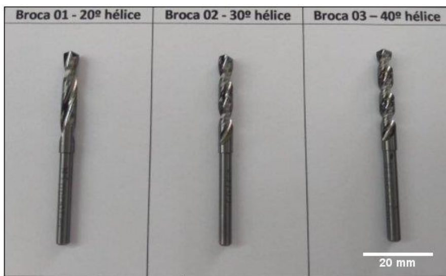
Figura 18 – Dimensões (em mm) das ferramentas utilizadas nos ensaios.
