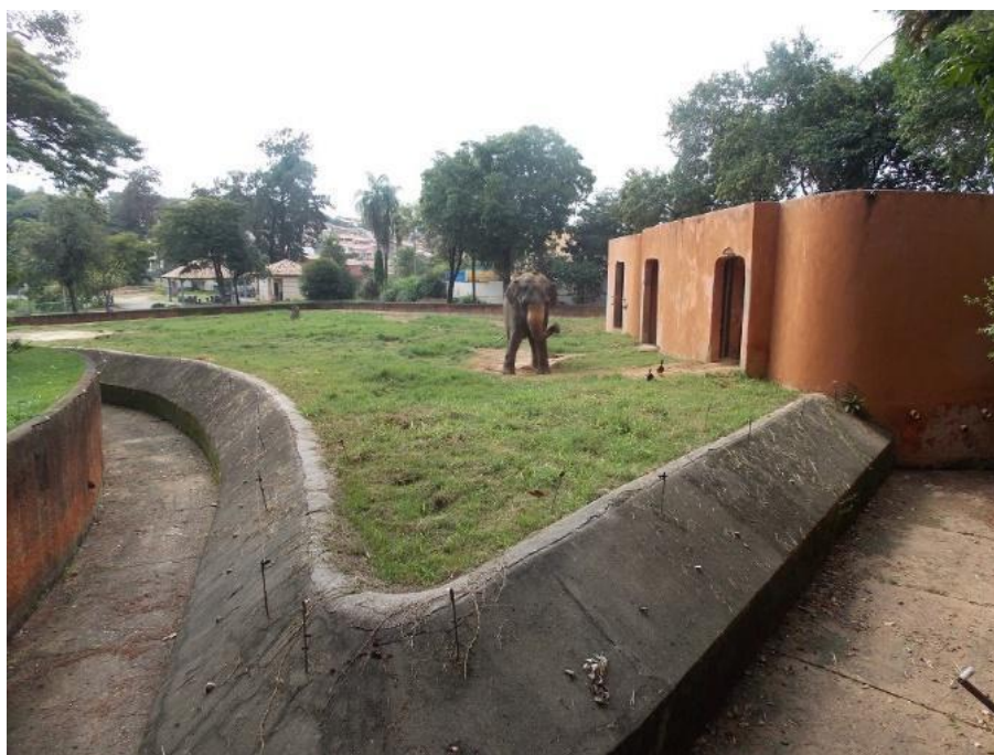
Figura 5 – Exemplo de estruturas de segurança no recinto. Na foto: fosso seco e cerca elétrica.
