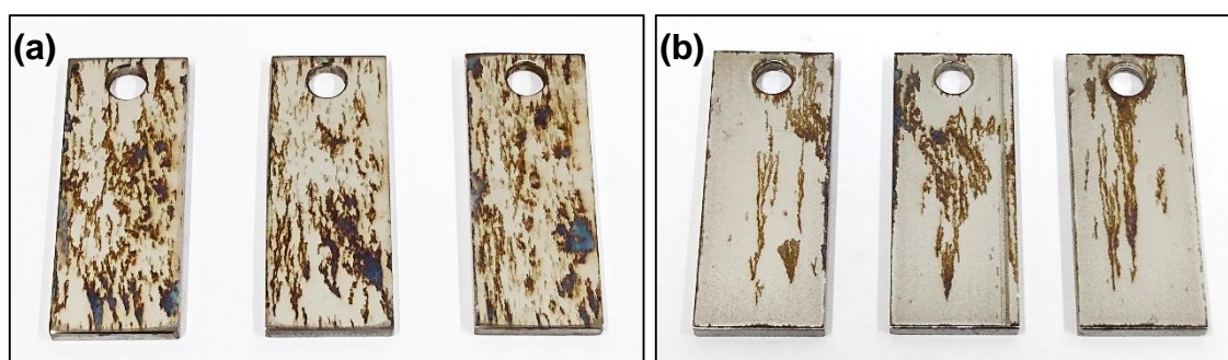
Figura 4.14 – Aspecto das amostras de aço X70 após 90 dias totalmente imersas em solução etanólica sintética sob agitação: (a) Microestrutura CR. (b) Microestrutura CRTT.
