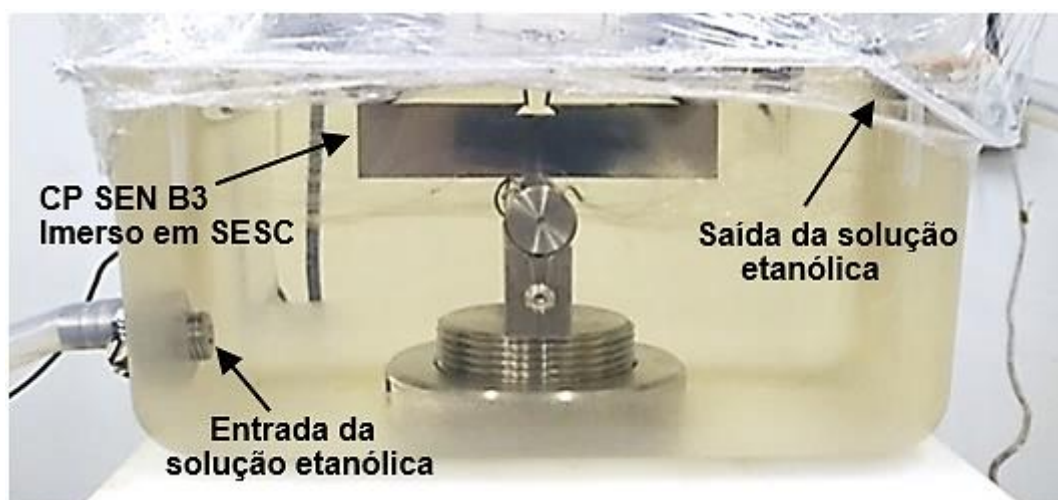
Figura 3.25 – Reservatório superior com o corpo de prova SEN B3 completamente imerso em solução etanólica circulante.
