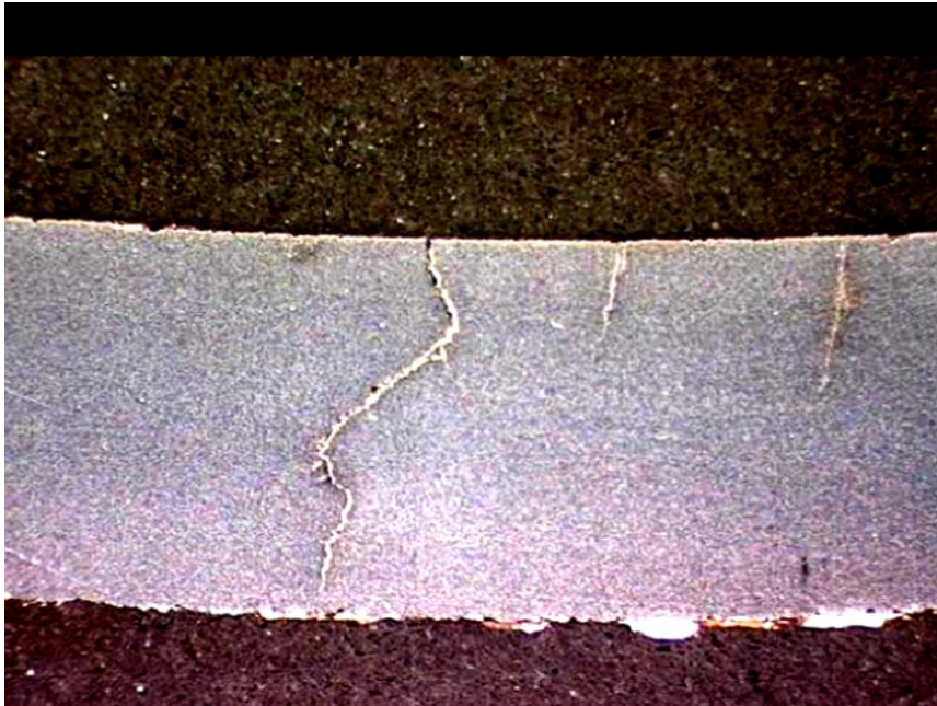
Figura 2.8 - Características de trincas de CST em aço carbono exposto ao etanol combustível, mostrando a iniciação e propagação de trincas na direção da espessura de uma tubulação [3, 4, 41].
