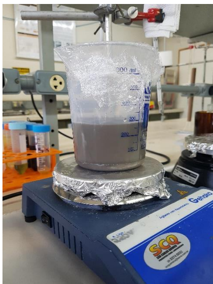
Figura 20 - Solução de poros de concreto simulada durante agitação eletromagnética
