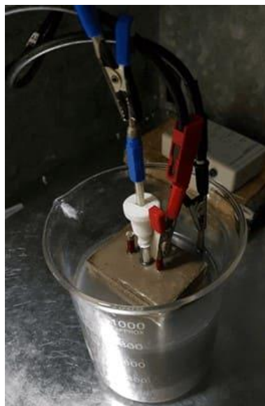
Figura 27 - Célula eletroquímica montada com amostra de compósito cimentício, RE, WE e CE na solução alcalina
