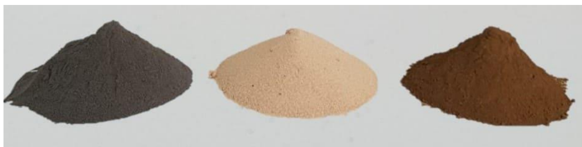
Figura 17 - Areia de cinza de bagaço de cana-de-açúcar (esquerda), areia fina (centro) e lodo de estação de tratamento de água (direita)
