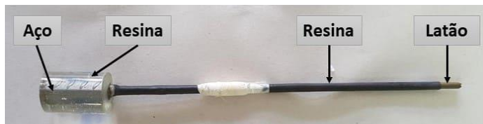
Figura 22 - Eletrodo de trabalho confeccionado de aço CA-60
