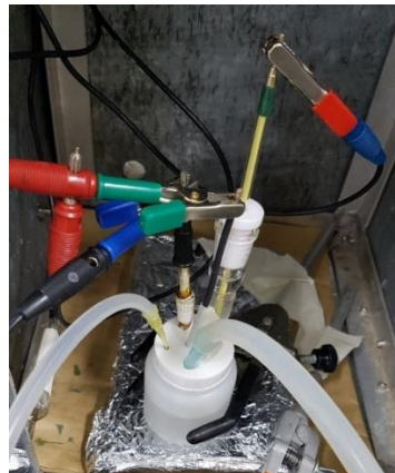
Figura 25 - Célula eletroquímica utilizada inserida na gaiola de Faraday
