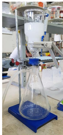
Figura 21 - Filtragem de solução de poros de concreto simulada contendo 3,5% de NaCl
