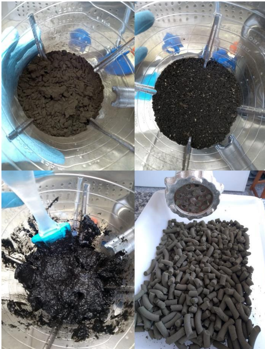
Figura 4. 12 - Imagens do arroz colonizado com Aspergillus niger após 7 dias de cultivo, arroz batido; amido gelatinizado incorporado no arroz e o grânulo biofertilizante após a extrusão a frio.
