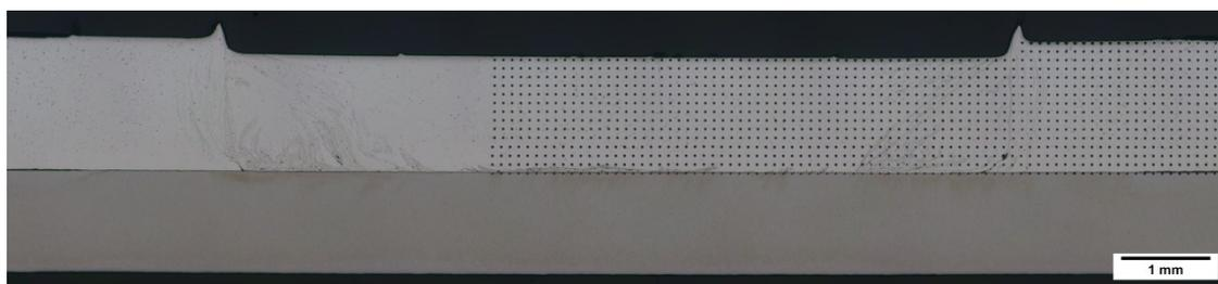
**Figura 16** – Seção transversal da solda após a realização do ensaio de microdureza, evidenciando a distribuição das indentações respeitando uma distância mínima de 0,1 mm, conforme indicado pela norma ASTM E384-11.
