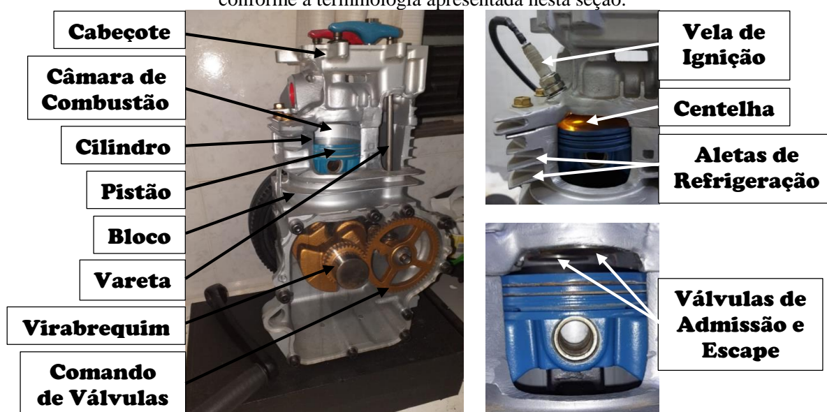
Figura 3.12 – Fotos mostrando as partes do motor de combustão interna utilizado neste trabalho, conforme a terminologia apresentada nesta seção.
