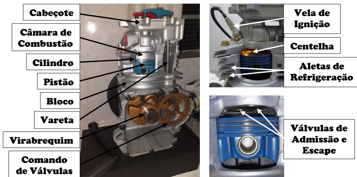
Figura A.12 – Fotos mostrando as partes do motor de combustão interna utilizado neste trabalho, conforme a terminologia apresentada nesta seção.
