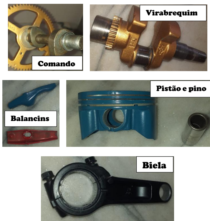
Figura A.6 – Foto das peças do motor pintadas em cores diferentes para facilitar a identificação e a visualização das mesmas durante o funcionamento do motor.
