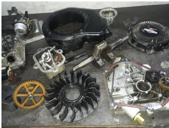
Figura A.2 – Foto do motor desmontado para a realização da limpeza, seleção das peças e adequação para ser utilizado em sala de aula como material didático.
