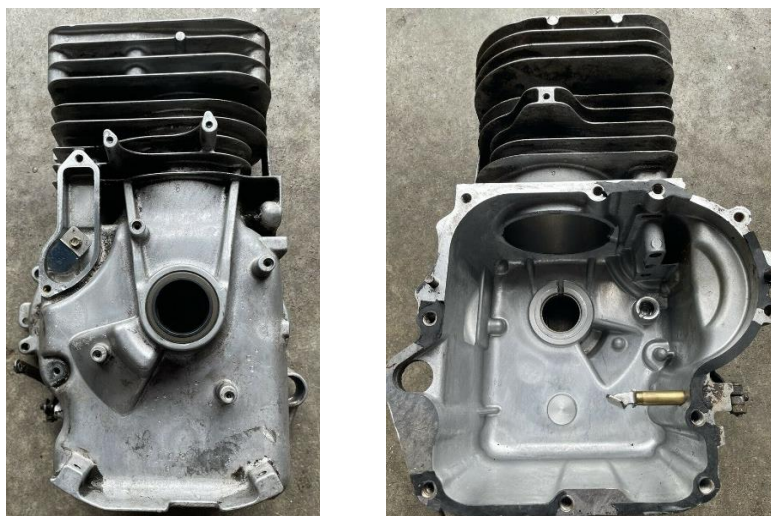
Figura A.3 – Foto da carcaça do motor desmontado após a limpeza.
