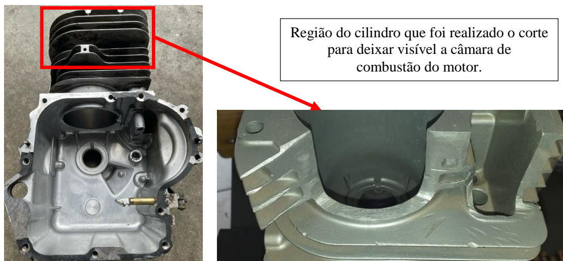
Figura A.4 – Foto mostrando uma parte do motor antes e depois do corte transversal feito na região superior do cilindro para facilitar a visualização do movimento do pistão do motor.
