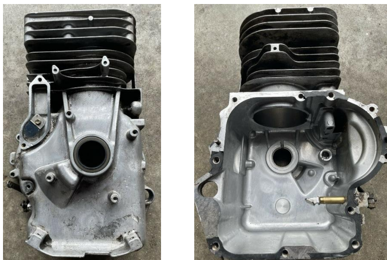
Figura 3.3 – Foto da carcaça do motor desmontado após a limpeza.
