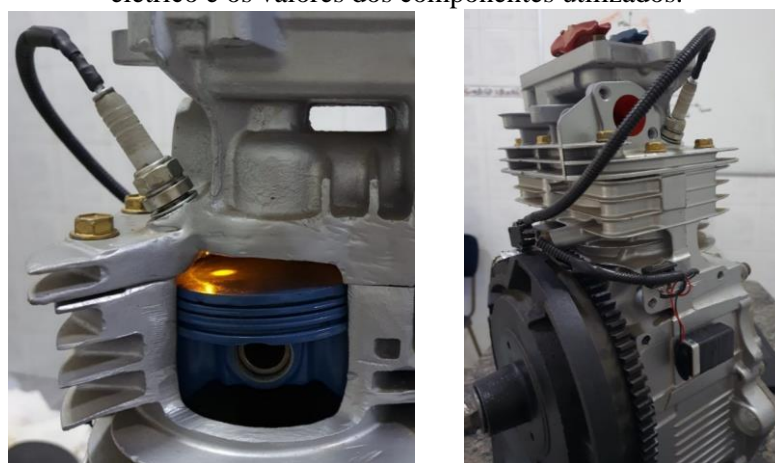
Figura 3.11 – Fotos mostrando uma lâmpada de LED adaptada na carcaça de uma vela de ignição (superior esquerda) e o correspondente circuito elétrico acoplado ao motor (superior direita) utilizado para acionar a mesma e simular a ignição da mistura ar-combustível na câmara de combustão no momento em que o pistão comprime a mistura no cilindro. Abaixo mostramos a malha do circuito elétrico e os valores dos componentes utilizados.
