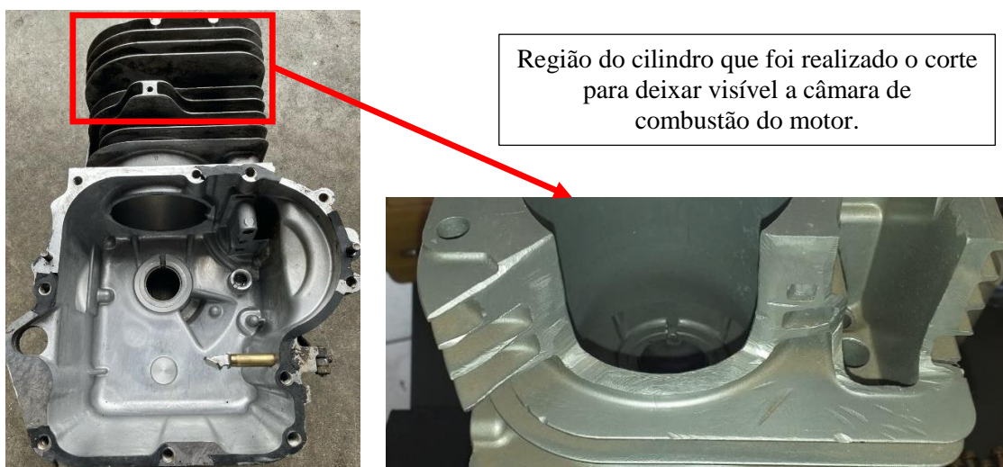
Figura 3.4 – Foto mostrando uma parte do motor antes e depois do corte transversal feito na região superior do cilindro para facilitar a visualização do movimento do pistão do motor.
