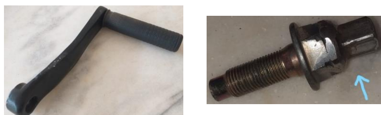
Figura 3.8 – À esquerda apresentamos uma imagem da manivela construída a partir de materiais reciclados e utilizada para facilitar a movimentação do motor durante as aulas. À direita é apresentado o parafuso utilizado para a fixação da manivela composto por uma chave de catraca quebrada (seta) soldada a um parafuso.
