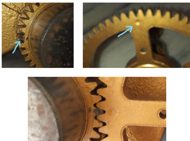
Figura 3.7 – Fotos mostrando as marcações de fábrica das peças do motor para facilitar a sincronização do sistema.
