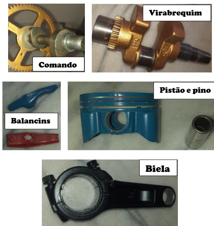
Figura 3.6 – Foto das peças do motor pintadas em cores diferentes para facilitar a identificação e a visualização das mesmas durante o funcionamento do motor.
