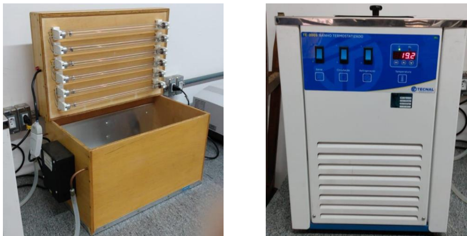
Figura 9. Ilustração do Fotoreator e equipamento de banho termostático utilizados nos testes de fotocatalise. Fonte. Autoria própria.
