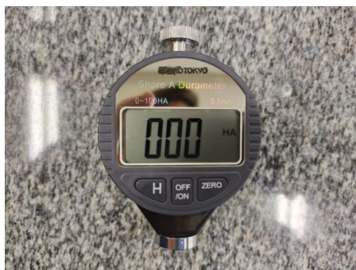
Figura 9 - Durômetro a ser utilizado para as medições
