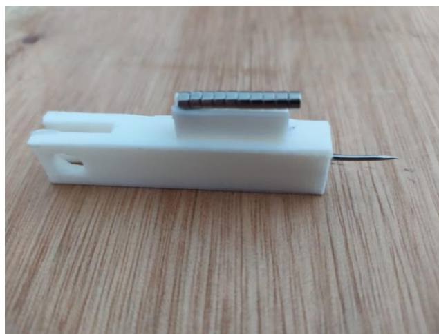
Figura 19 – Barra deslizante com suporte + ímãs + ponta metálica
