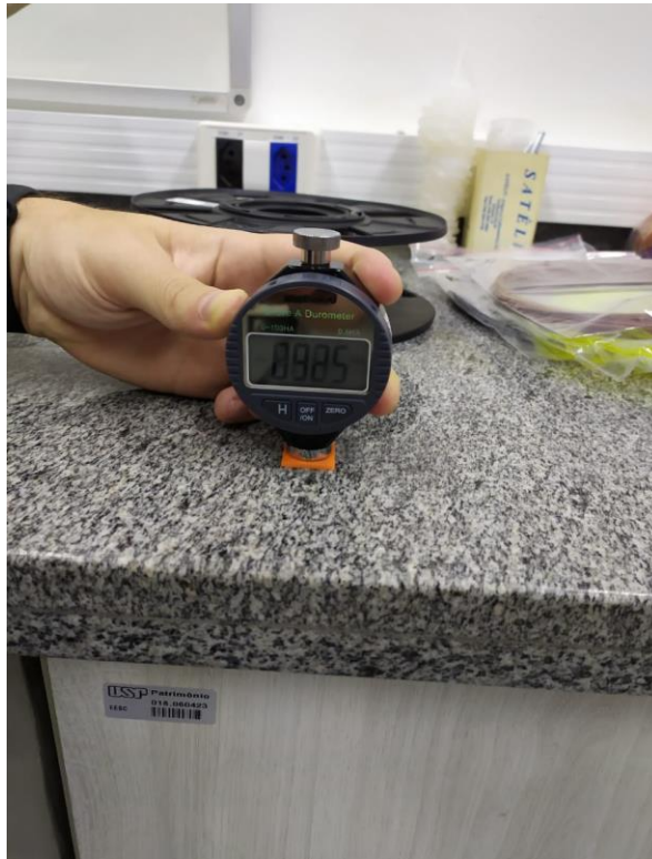
Figura 10 - Ensaio de dureza realizado
