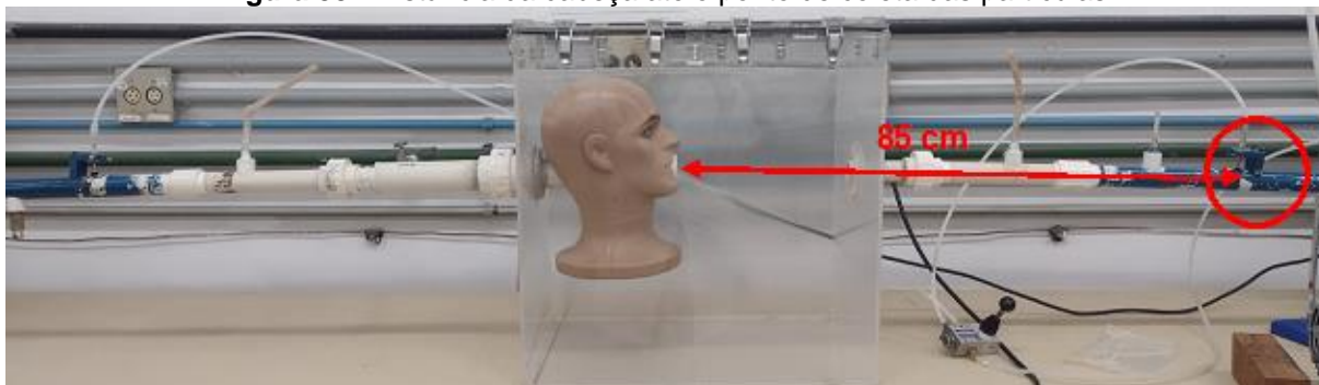
Figura 33 - Distância da cabeça até o ponto de coleta das partículas.
