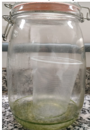
Figura 13 - Respirômetro C2.2 contendo a presença de microalgas fotossintetizantes.
