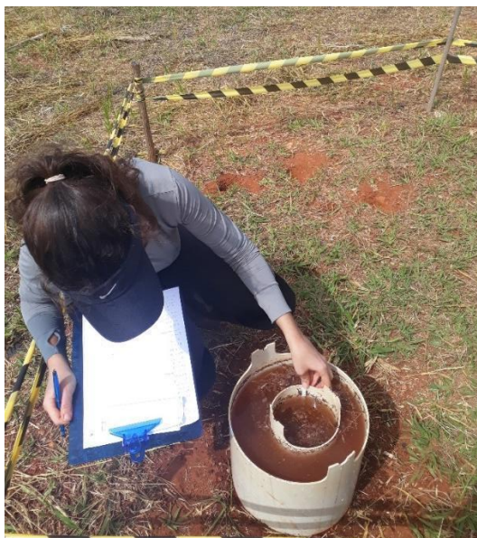
Figura 12: Medição da infiltração com o uso do infiltrômetro de duplo anel. Autoria própria.
