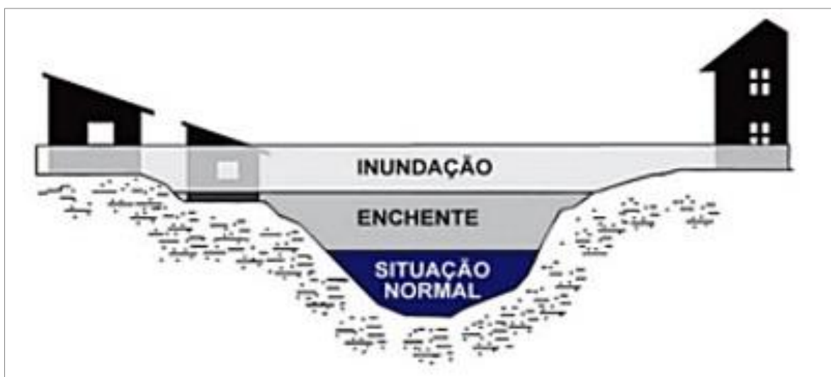
Figura 3: Perfil esquemático do processo de enchentes e inundações. Fonte: Ministério das Cidades/IPT, 2007).
