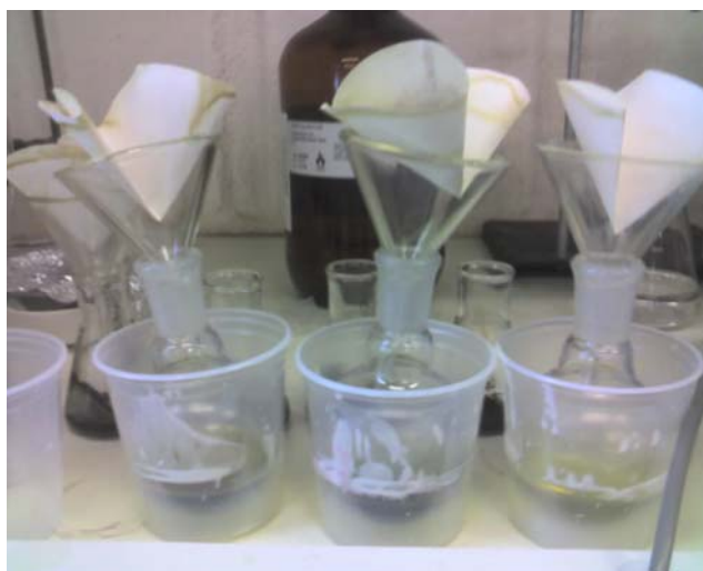
Figura 9 – Parte do processo de extração em sedimento
