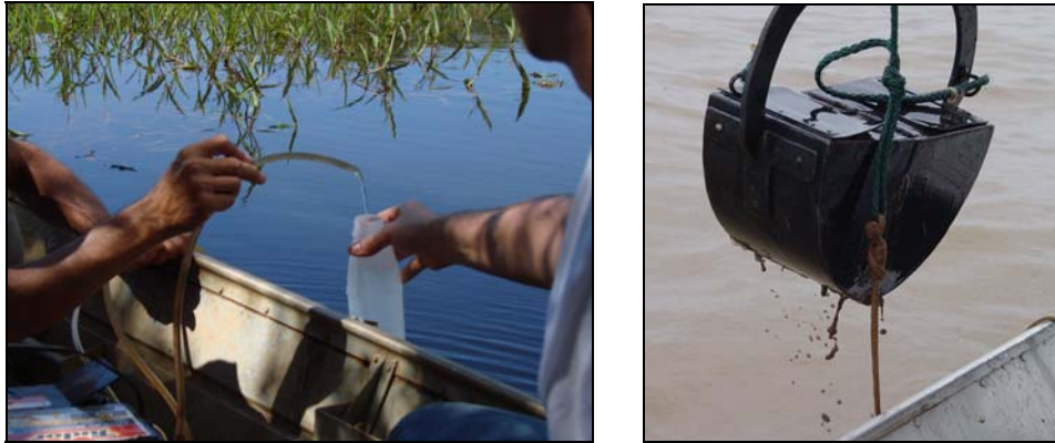
Figura 7 - Coleta de água com bomba de imersão e coleta de sedimento com draga tipo van-Veen (fotos de André Moldenhauer Peret).
