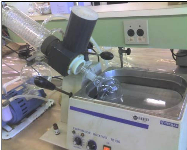
Figura 11 – Concentração de amostra em evaporador rotativo.
