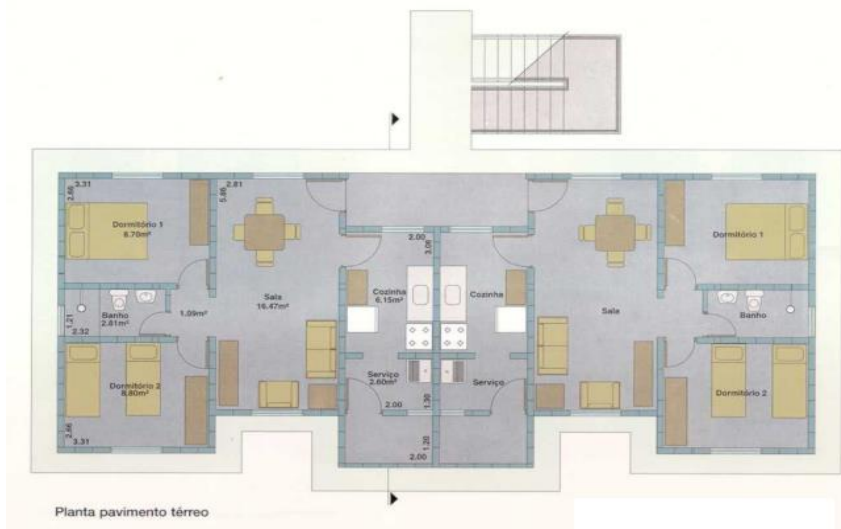
Figura 16 - Planta baixa casas sobrepostas (SB22A) - Pavimento térreo
