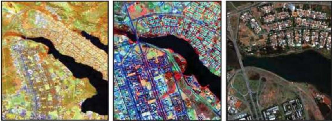
Figura 1 - A primeira representa imagens dos satélites, Landsat com resolução espacial de 30m, Spot com 10 m e Ikonos com 1 m, de uma porção do lago Paranoá de Brasília. Fonte: MENESES & ALMEIDA, 2012.
