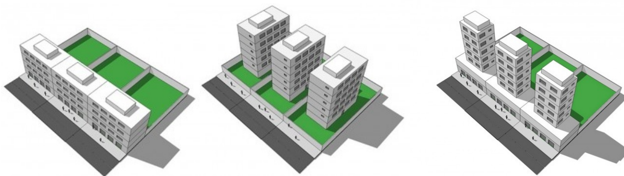
Tipos 3 e 1 – Mesmo volume construído em diferentes posições dentro do lote e com diferentes relações com a rua.
