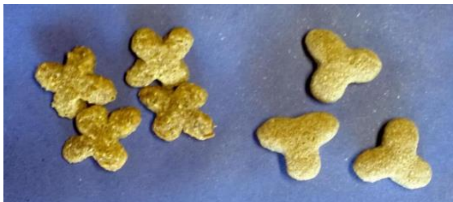
Figura 2.3 – Croquetes de um mesmo produto quando extrusados com telas de 1,2 mm (esquerda) e com telas de 0,6 mm (direita)
