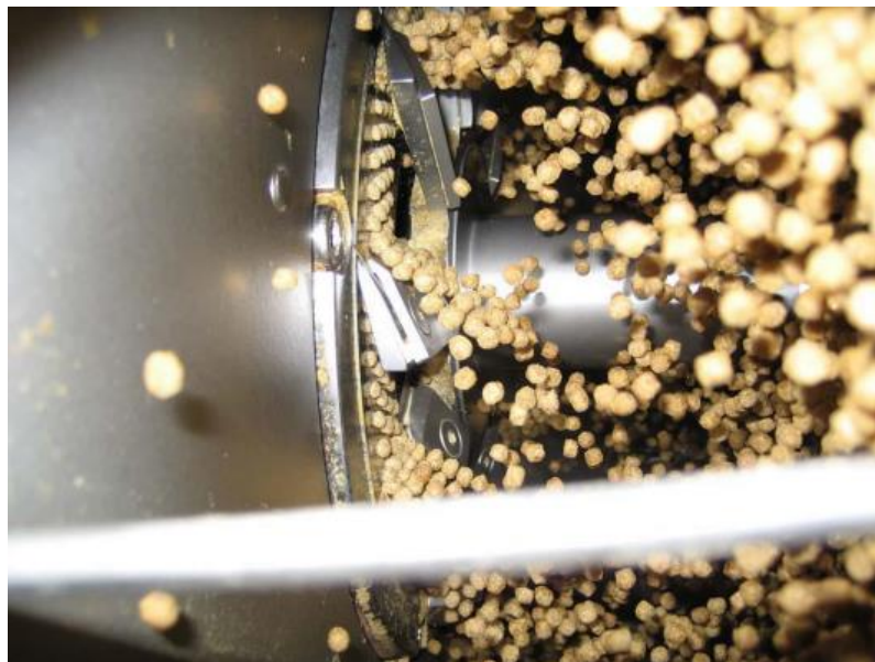
Figura 2.7 – Matriz em funcionamento ilustrando a formação dos croquetes
