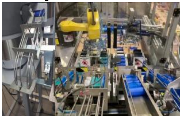
Figura 22: Sistema de calhas
