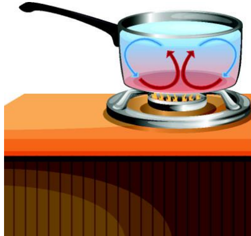
Figura 2.8 - Representação gráfica da convecção natural
