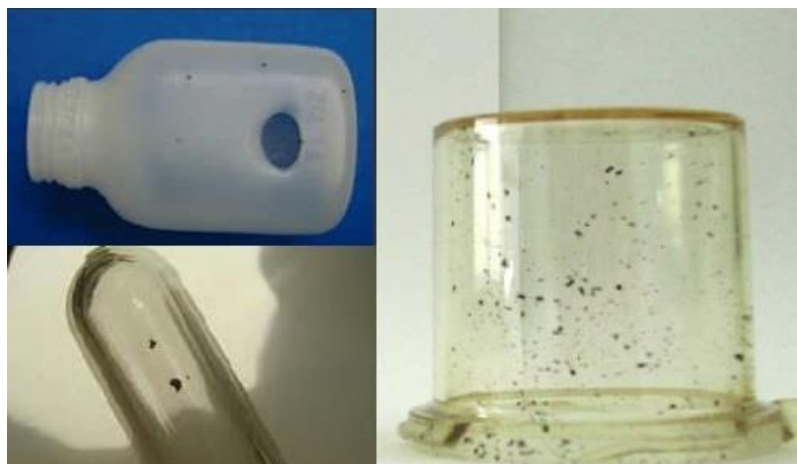
Figura 5. Presença do PVC no processo de injeção e sopro do PET
