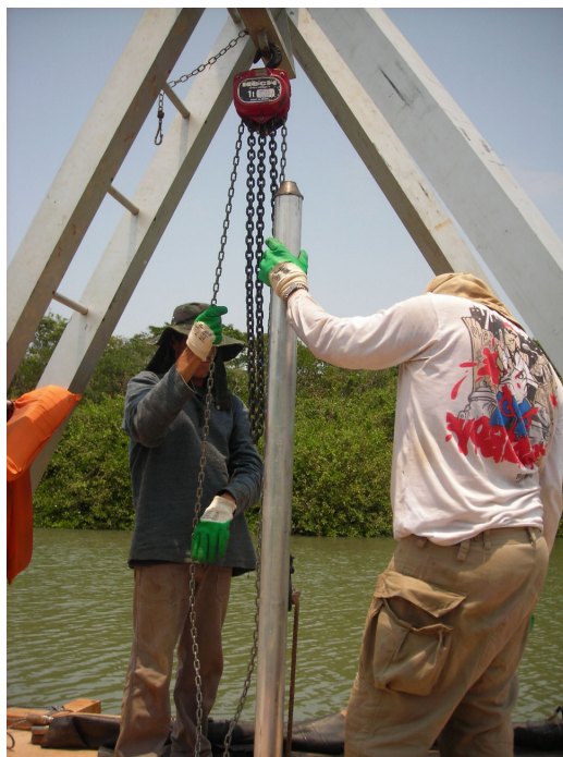
Figura 15 – Talha acoplada ao tripé para içamento dos testemunhos.
