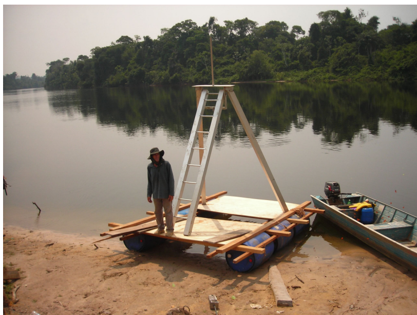
Figura 14 – Balsa construída em madeira, suportada por seis bombonas plásticas de 200 litros para suporte da plataforma de coleta.
