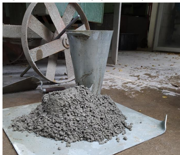
Figura A7 – Desagregação do traço EA80
