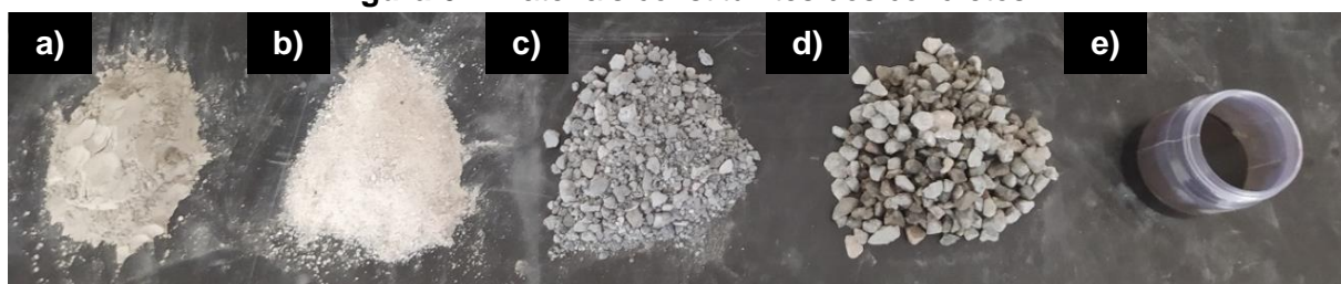
a) CP V-ARI; b) Areia natural; c) Escória de aciaria BSSF; d) Brita natural; e) Aditivo químico
