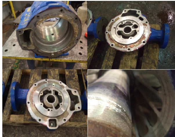
Figura 29 – Condições internas com desgaste da Bomba P-1063B
