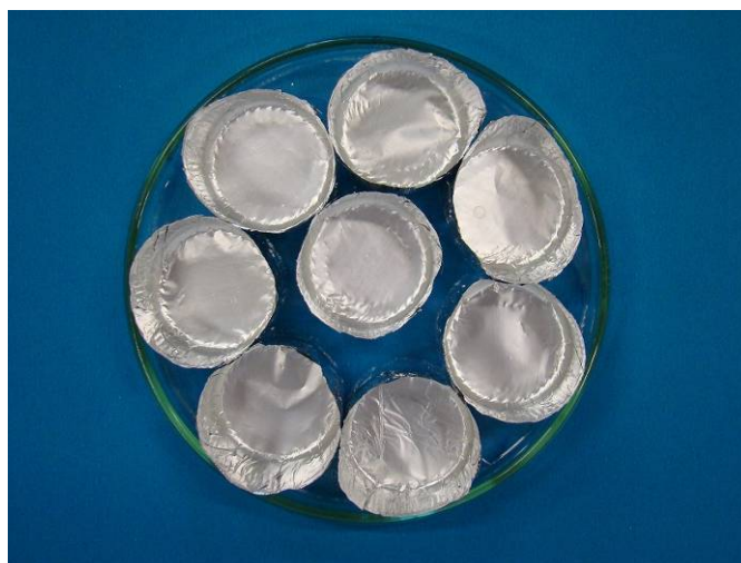
Figura 13: Vista geral dos cadinhos confeccionados em papel alumínio e utilizados para determinação do peso seco dos itens alimentares pelo método gravimétrico.
