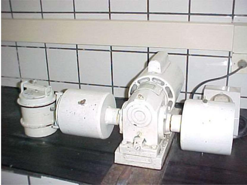
Figura 3.8 - Equipamento utilizado para analisar a friabilidade. Cortesia da Elfusa.
