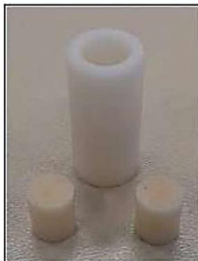
Figura 4.39 - Porta amostra utilizado para ensaio de dilatométrica de pós.
