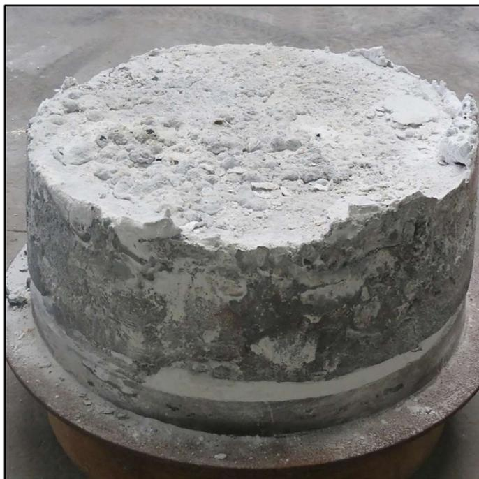
Figura 3.2 - Bloco de óxido de alumínio branco obtido no forno piloto da Elfusa.
