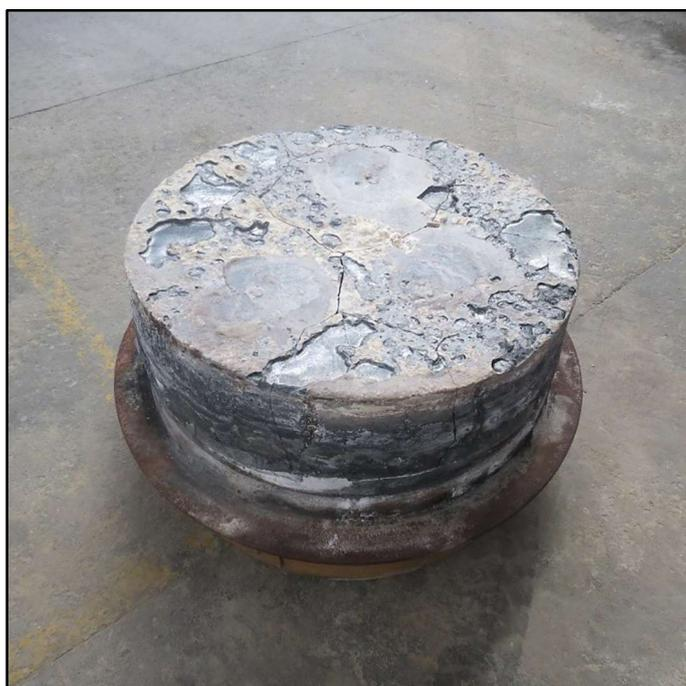
Figura 3.3 - Bloco de óxido de alumínio branco com nióbia obtido no forno piloto da Elfusa.
