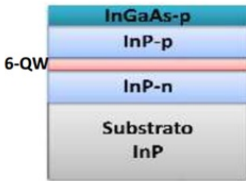
Fig. 1. Modelo planar dos poços quânticos usado para a fabricação do laser. Fonte: LACERDA [5].
