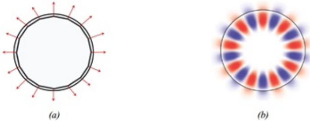
Fig. 3. Demonstração planar de uma cavidade ressonante. (a) Emissão da radiação radial na borda da cavidade ressonante. (b) Ressonâncias e onda evanescente na borda da cavidade. Fonte: Adaptado de [6]
