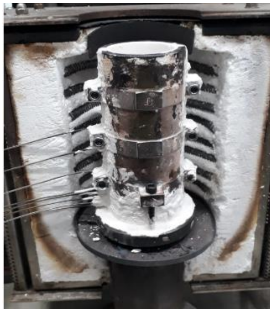
Figura 9 - Lingoteira montada com termopares posicionados para vazamento do metal líquido e sequência de solidificação direcional.
