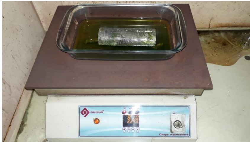
Figura 11 – Ataque químico com reagente Água Régia em chapa aquecedora para revelação da macroestrutura da liga 28Cr48Ni5W3Co.
