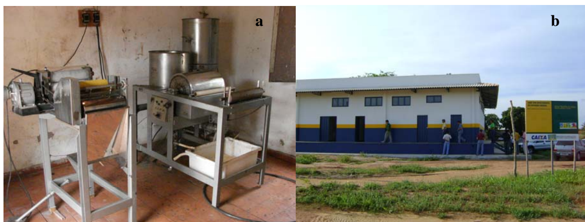
Figura 4: a) Usina de processamento de cera alveolada, composta por: derretedor, laminador, alveolador e fatiador; b) Entreposto de mel em Cáceres MT (2009).
