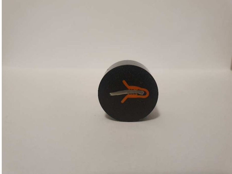
Figura 20: Amostra da ponta do gancho embutida para realização de metalografia.
