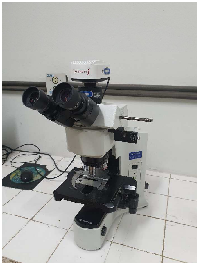
Figura 12: Microscópio Olympus, modelo BX41-LED com câmera Infinity 1 acoplada.
