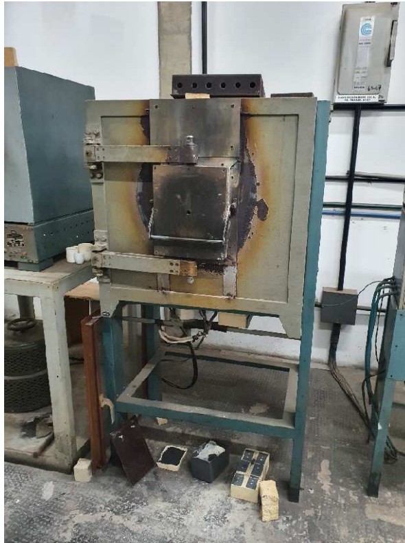
Figura 15: Forno Elétrico BP utilizado para aquecimento da amostra de aço durante o forjamento.
