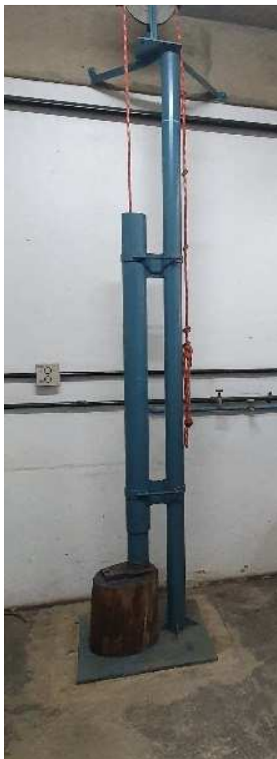
Figura 16: Mecanismo utilizado para a realização da etapa de forjamento a partir da queda livre de um cilindro de 30 Kg.
