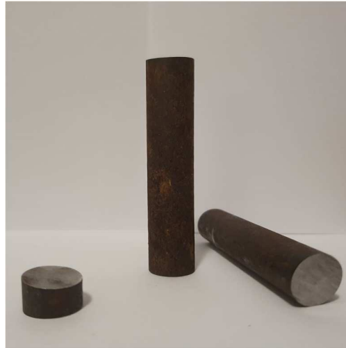
Figura 9: Amostras de aço médio carbono desconhecido cortadas utilizando disco de corte.
