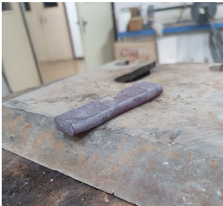
Figura 17: Amostra metálica após passar pela etapa de forjamento de queda por gravidade.
