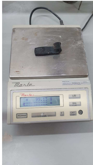
Figura 19: Pesagem da amostra após o forjamento, utilizando uma balança de precisão Marte AS 2000.
