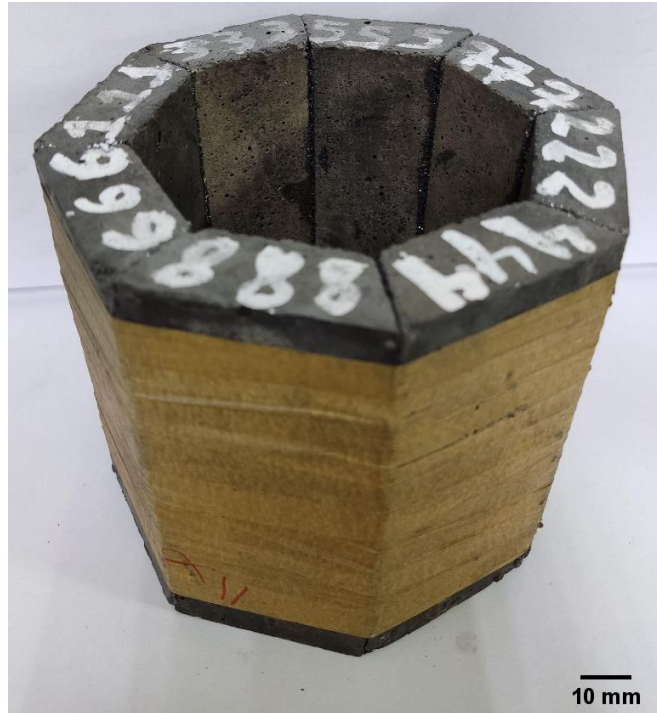
Figura 8: Conjunto de amostras para o ensaio de corrosão dinâmica, posicionadas em formato octaédrico antes de colocá-las no cadinho e no forno.
