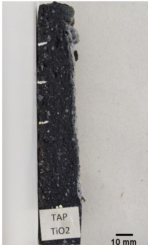
Figura 11: Seção cortada do corpo de prova após o ensaio de corrosão, com indicações nos locais onde a medição foi realizada.
