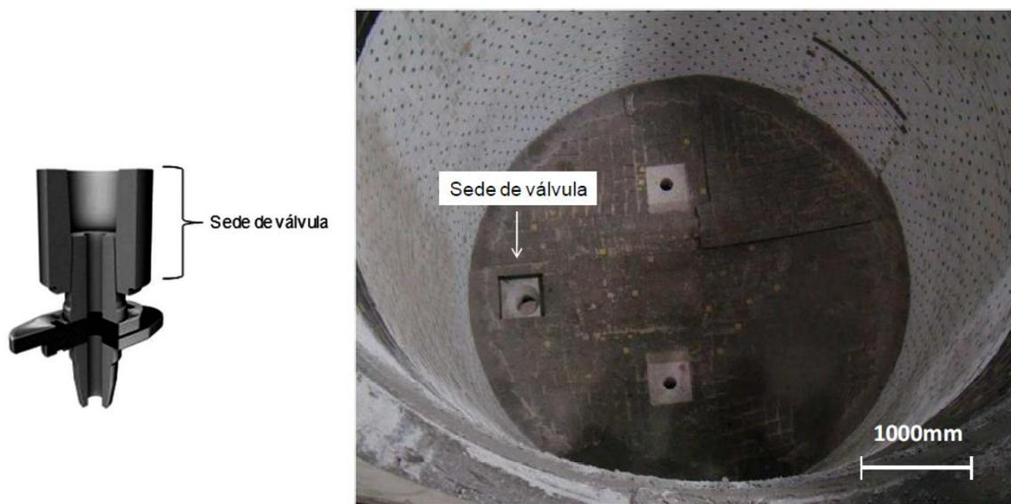
**Figura 3** - Posicionamento da sede de válvula no fundo da panela antes da primeira corrida (SAKO, 2012).
